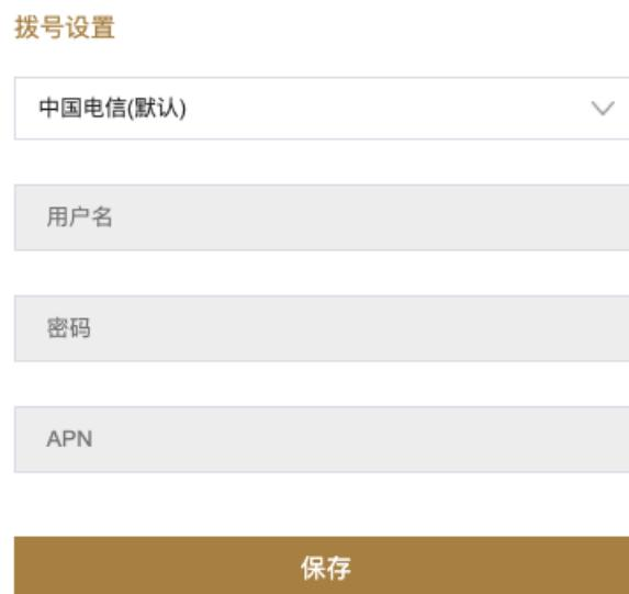
点击左侧下三角按钮，可显示拨号配置，一般情况下不需要设置就能拨号上网。若无法正常拨号上网，请与相应的运营商联系，使用运营商提供的用户名、密码以及 APN 号填写，选择自定义设置拨号参数。
