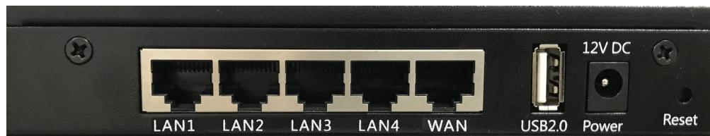
**WAN 接口**：广域网接口，用于连接可以连接互联网的网线。
