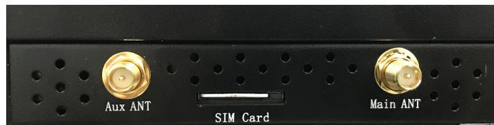
**SIM 卡接口**：4G 通信模块的 SIM 卡接口。请在关机状态下插入 SIM 卡，SIM 卡芯片朝上缺口朝内插入；若要取出则再按压一次就会弹出。海外移动运营商可能需要配置 APN 才能拨号上网，具体 APN 请与当地运营商联系获取，设置 APN 的方法请看后面章节。
