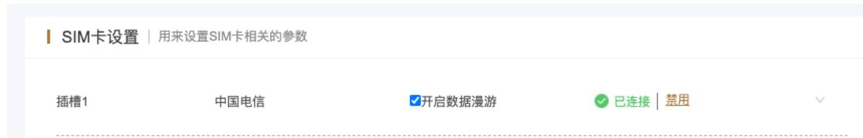
如图，该槽位的 SIM 卡当前状态是已连接，按“禁用”按钮可以断开当前 SIM 卡对应的 4G 卡的通信链路。可以设置是否开启数据漫游，该复选框选中后，对应的 SIM 卡开启数据漫游功能(默认开启)。否则，禁止数据漫游功能。
